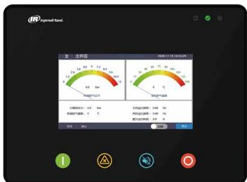
**RM200-250i/n 微油螺杆空压机：**采用新一代Luminance系列控制器，拥有强大的控制以及远程管理功能，保证您的压缩机稳定运行的同时，大幅提升压缩机的运行与管理效率
